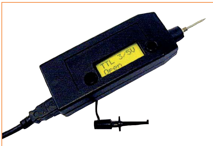
Bild 1. Der Multitester von Thomas Ücok basiert auf dem Minimod-Modul.
